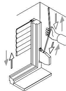
**Ouverture/fermeture avec une manivelle**
